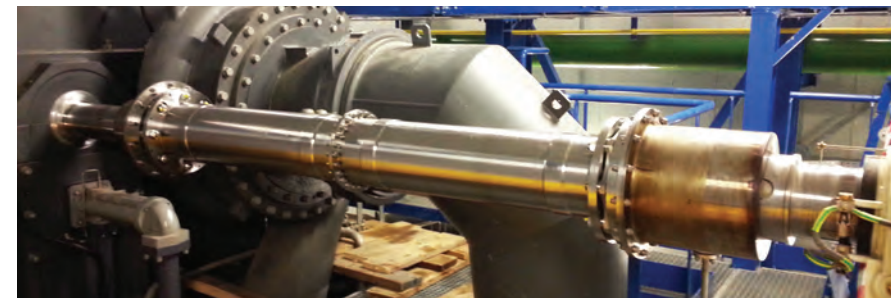
Воздушный компрессор для воздухоразделения
