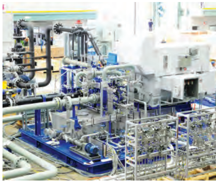
Компрессор высокого давления для терминалов СПГ
