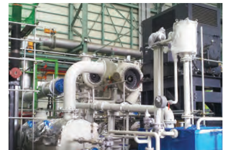
Воздушный компрессор для воздухоразделения
